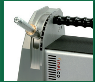
Schleifwinkel-Einstellung von 7,5-90 Grad ergibt einen Spitzwinkel zwischen 15 und 180 Grad.
